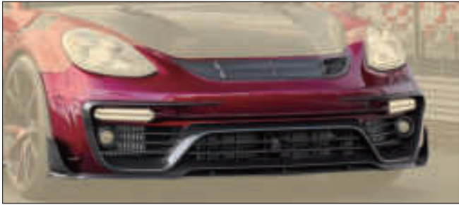
前保险杠-带车距控制系统雷达 97X 102 001 前保险杠-无车距控制系统雷达 97X 102 002 前唇, 前分流器, 可视碳纤维, 不带清漆, 进气口格栅, 发动机罩前进气口格栅, 带漆, 不可视碳纤维, 不带清漆
