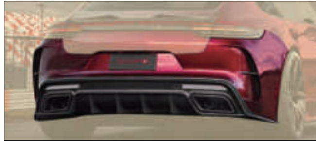
后保险杠 97X 802 001 扩散器, 可视碳纤维, 不带清漆, 排气尾喉 ①获得原后保险杠反射镜
