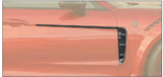
翼子板及门板饰条 97X 131 871 2件套-左&右,带MANSORY标志 可视碳纤维, 不带清漆
