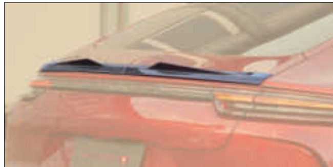
后翼扰流器 97X 830 301 3件套, 后扰流器空气动力设计, 可视碳纤维, 不带清漆
